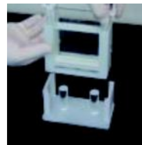
6. 电泳后,取出缓冲液,使用取出器将凝胶板取出。
