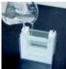
4. 在V-cell固定装置(阴极缓冲液槽)中装入电泳缓冲液。
